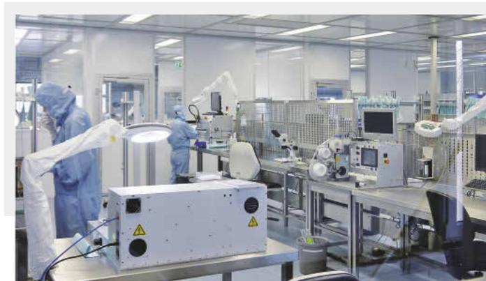
Der mit 180 m<sup>2</sup> größte Reinraum der Anlage Clean Medi Cell bietet Platz für die Montagelinie, auf der Katheter- und Stentsysteme hergestellt werden
