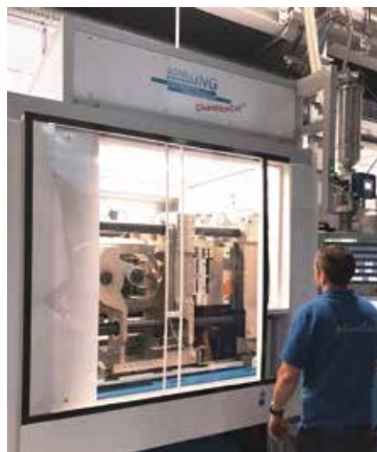
▲ Ein Laminar-Flow-Aufsatz spült die unmittelbare Produktionsumgebung der Pipetten schon während des Spritzgussprozesses mit Reinstluft.
